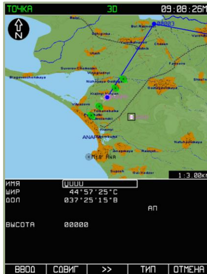
7-115: Ввод типа навигационной точки – АП (АЭРОПОРТ)
