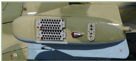
2-11: Устройство выброса ЛТЦ УВ-26. Левый красный АНО и кассета с комплектом сигнальных ракет
