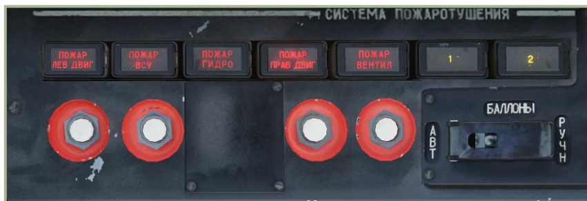
10-19: Панель управления системами пожаротушения
