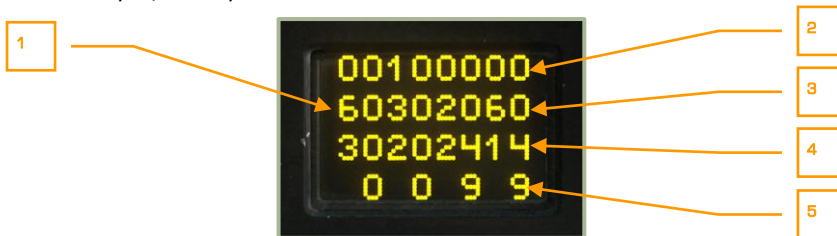
6-23: Цифровые коды сигналов, поступающих на распечатку через 8 с после посадки
