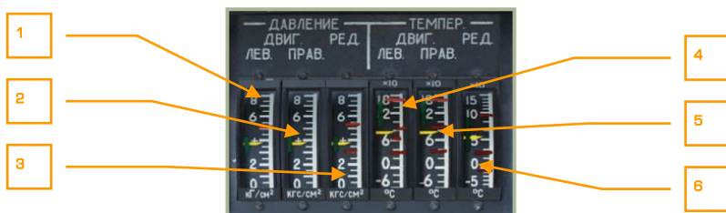
6-56: Пульта правый боковой, панель индикаторов давления, температуры масла двигателей и редуктора
