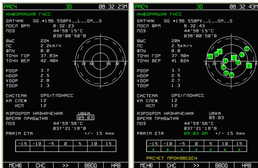
7-38: Подготовка данных и выполнение расчетов на аэропорт Анапа
