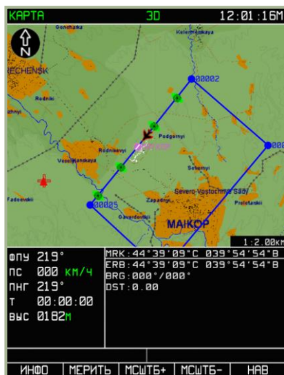
7-26: Определение начала отрезка измерения от объекта (произвольной точки)
