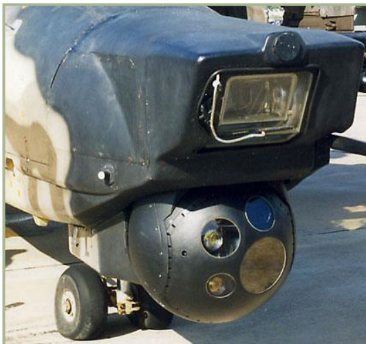
1-14: Носовая часть Ка-50Ш. Сверху расположен комплекс «Шквал», снизу в сферической турели – «Самшит-50»
