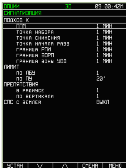
7-44: Вид дисплея в подрежиме СИГНАЛИЗАЦИЯ
