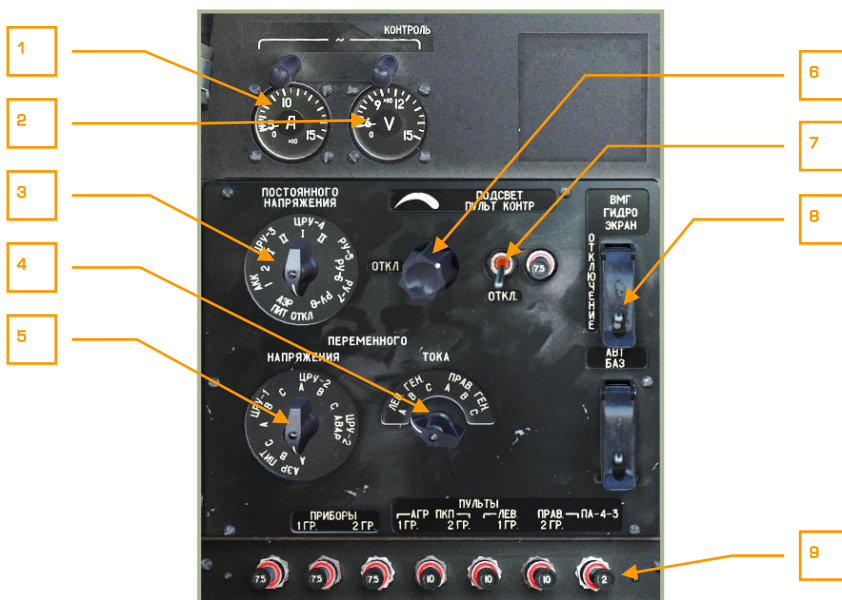
6-69: Нижняя панель пульта контроля
