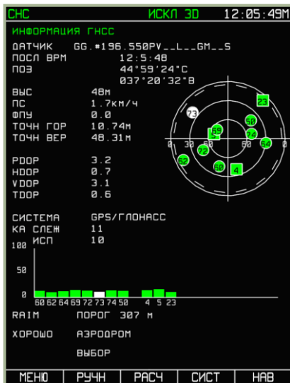
7-34: Вид дисплея при исключении из расчетов данных спутника № 73
