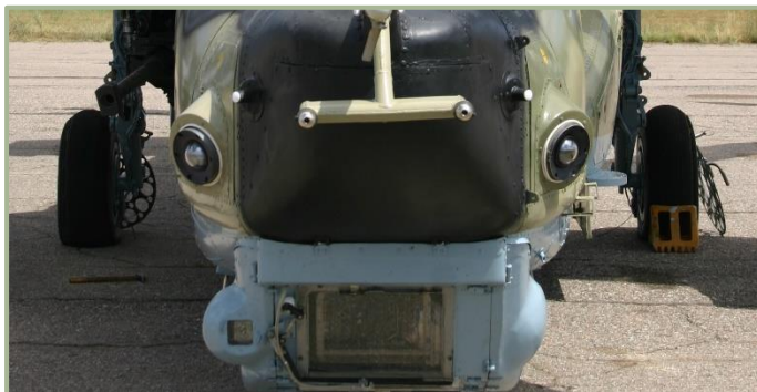
2-10: Носовая часть Ка-50. Внизу, слева – датчик оповещения о лазерном облучении системы «Отклик». Выше, слева и справа – УФ пеленгаторы системы предупреждения о пуске ракет. Чуть, выше и к центру – пара антенн ответчика госопознавания (белые).
