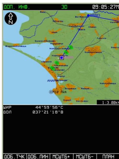
7-112: Вид дисплея в режиме ввода дополнительной информации
