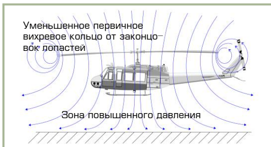
4-15: Схема воздушных потоков с учетом эффекта земли
