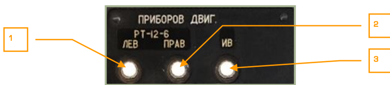
6-62: Панель контроля приборов двигателей
