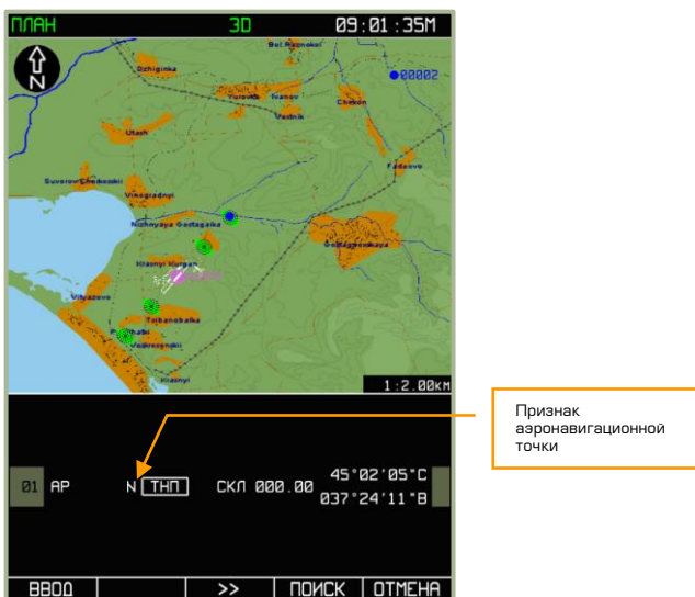
7-51: Вид дисплея при вводе ППМ, когда под активным маркером на поле карты есть аэронавигационная точка
