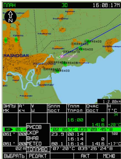
7-73: Выбор функции ввода сведений о наличии топлива ТОПЛИВО
