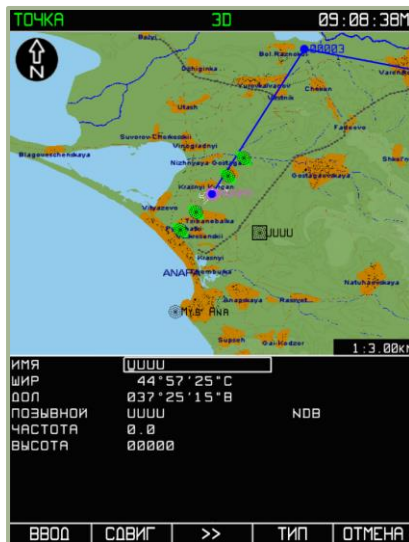
7-117: Ввод типа навигационной точки – NDB (ОПРС)
