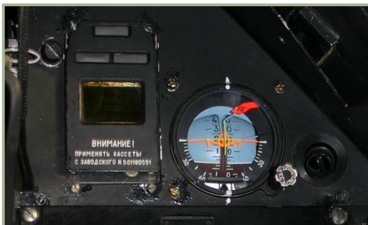
2-5: Система «Экран» (слева) и дублирующий авиагоризонт (справа) в кабине Ка-50
