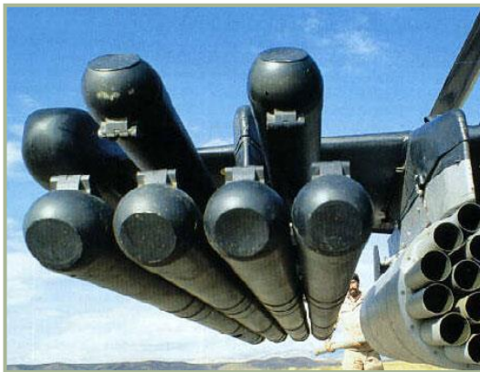
1-5: Противотанковые ракеты «Вихрь» на пусковой установке АПУ-6
