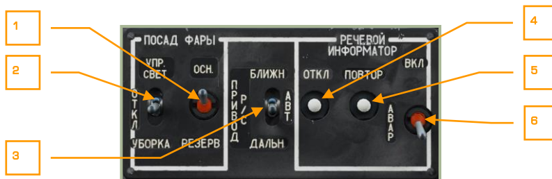
6-40: Пульт управления освещением, переключением каналов АРК и речевым информатором
