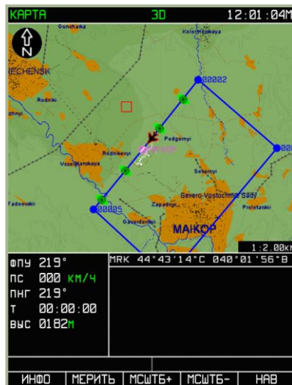
7-22: Вид дисплея в подрежиме КАРТА при выполнении функции ИНФО
