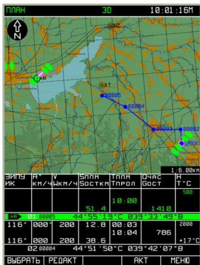
7-108: Результат инвертирования плана полета
