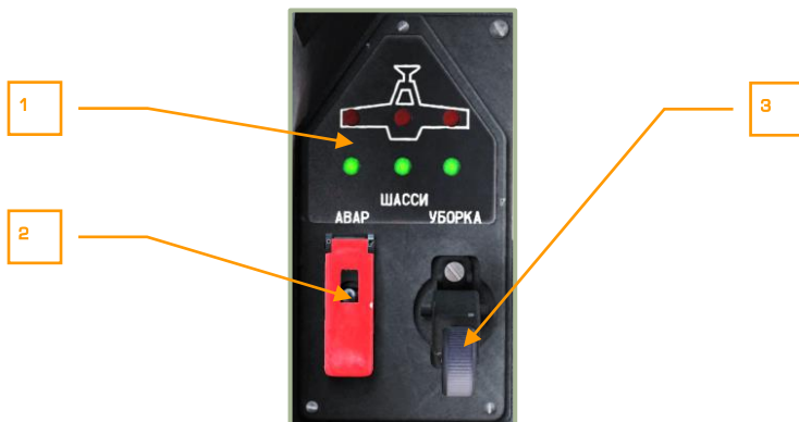
6-29: Щиток управления шасси
