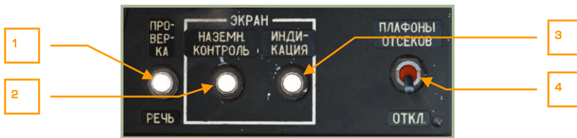
6-65: Пульт контроля системы ЭКРАН, кнопка проверки речевого информатора АЛМАЗ, выключатель плафонов отсеков
