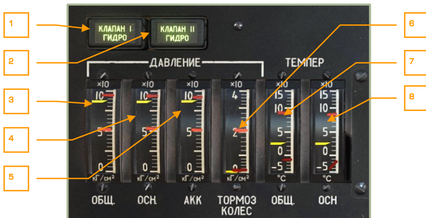
6-66: Индикаторы давления и температуры в гидросистемах
