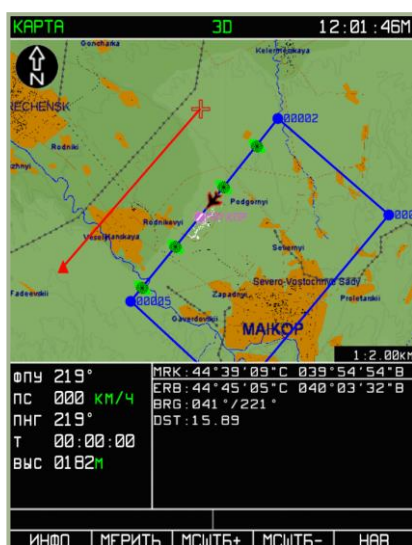
7-27: Измерение между объектами (произвольными точками)
