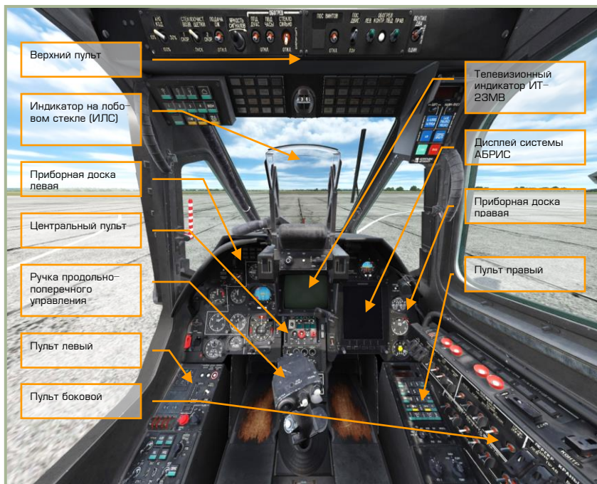
6-1: Схема расположения приборных досок, панелей и пультов управления
