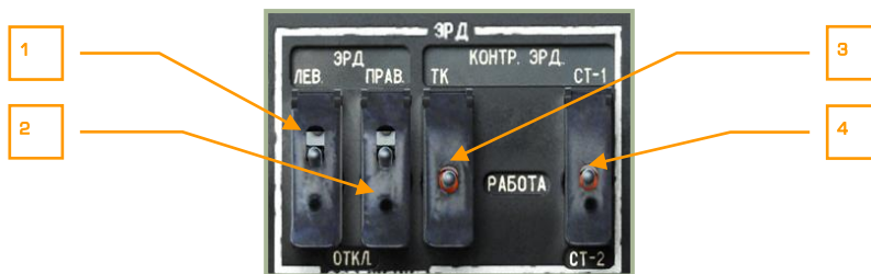
6-59: Пульт правый боковой, панель управления электронными регуляторами двигателей
