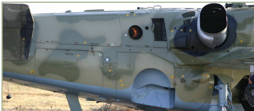
2-3: ЭВУ двигателя и выхлопное устройство вспомогательной силовой установки (в работе)
