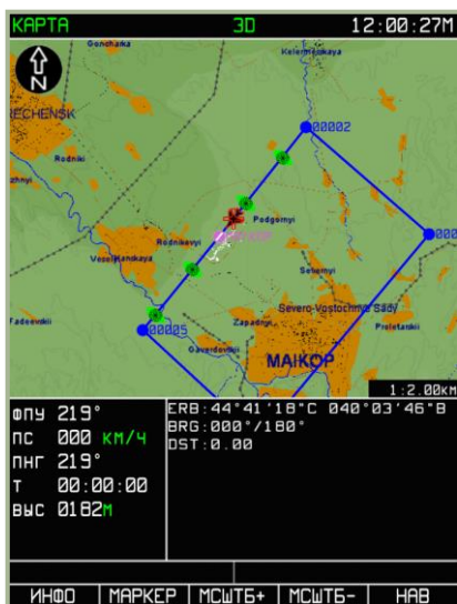
7-24: Вид дисплея при активизации функции МЕРИТЬ
