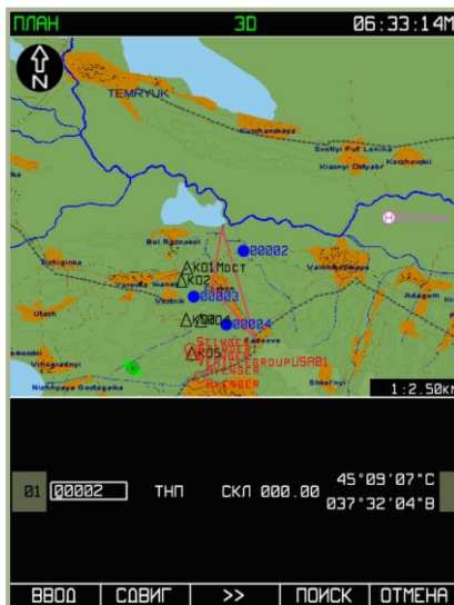
7-54: Вид дисплея при успешном завершении поиска точки
