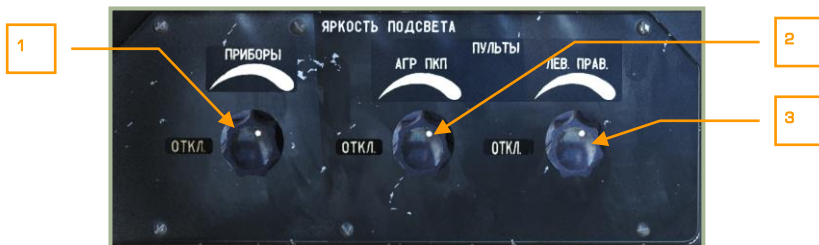
6-70: Панель регулировки яркости подсветки
