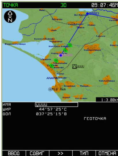
7-114: Ввод типа навигационной точки – ГЕОТОЧКА
