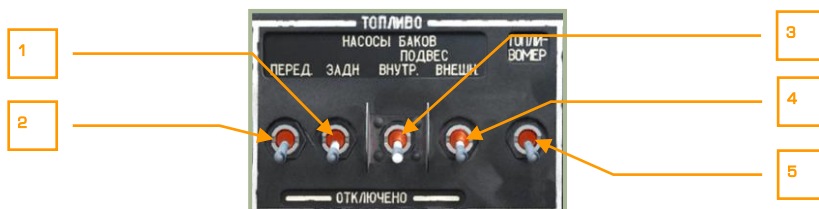
6-53: Пульт правый боковой, панель управления топливными насосами
